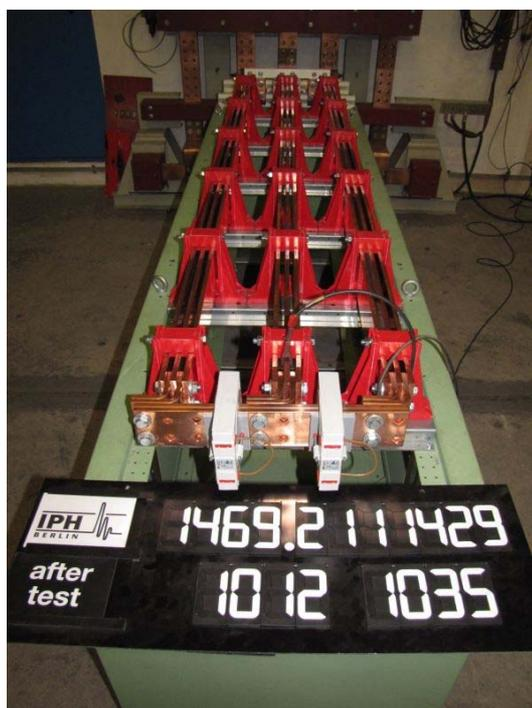
Foto 2: Sammelschienensystem E, Aufbau A1, Stützabstand 400 mm nach der Prüfung der Kurzschlussfestigkeit
