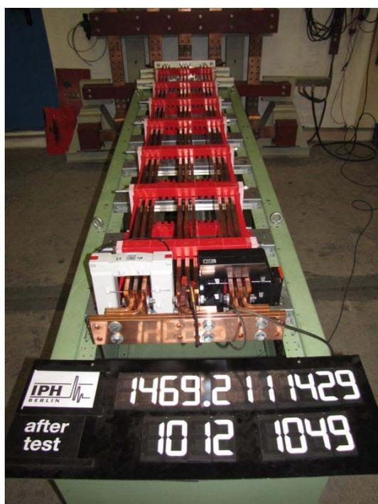
Foto 6: Sammelschienensystem G, Aufbau E4 nach der Prüfung der Kurzschlussfestigkeit
