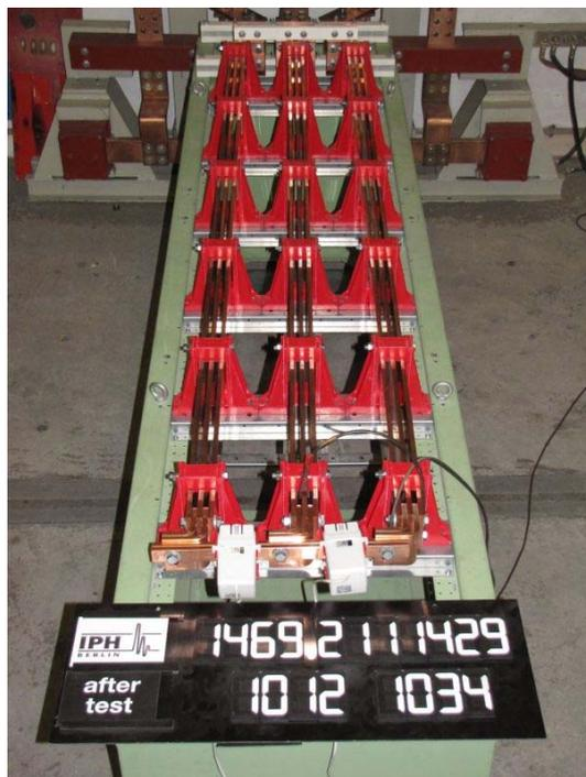
Foto 1: Sammelschienensystem E, Aufbau A1, Stützabstand 400 mm nach der Prüfung der Kurzschlussfestigkeit
