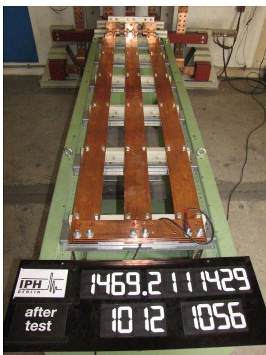
Foto 8: Sammelschienensystem Z nach der Prüfung der Kurzschlussfestigkeit
