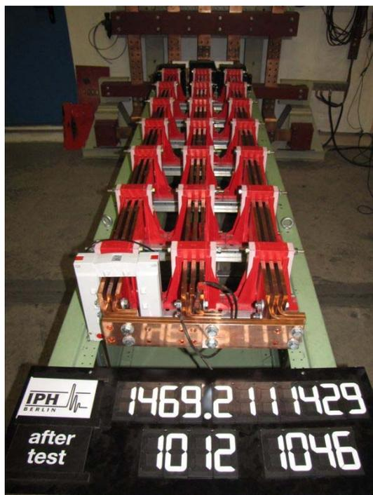
Foto 5: Sammelschienensystem E, Aufbau B3 nach der Prüfung der Kurzschlussfestigkeit
