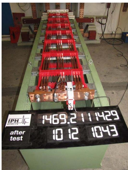
Foto 4: Sammelschienensystem G, Aufbau D2 nach der Prüfung der Kurzschlussfestigkeit
