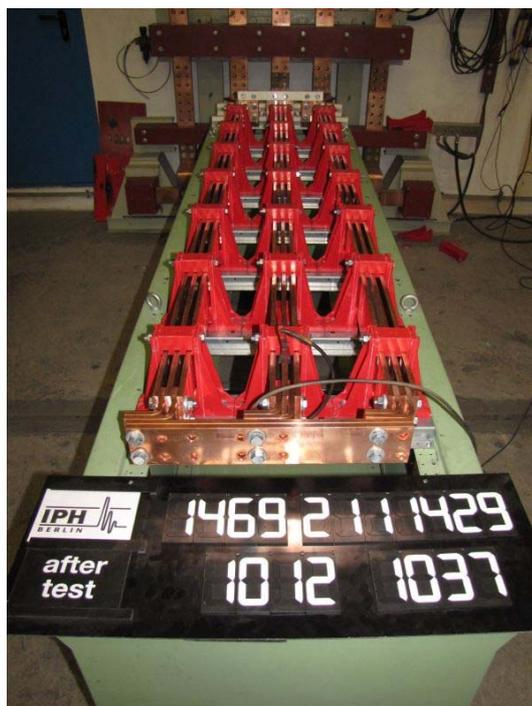
Foto 3: Sammelschienensystem E, Aufbau A1, Stützabstand 300 mm nach der Prüfung der Kurzschlussfestigkeit
