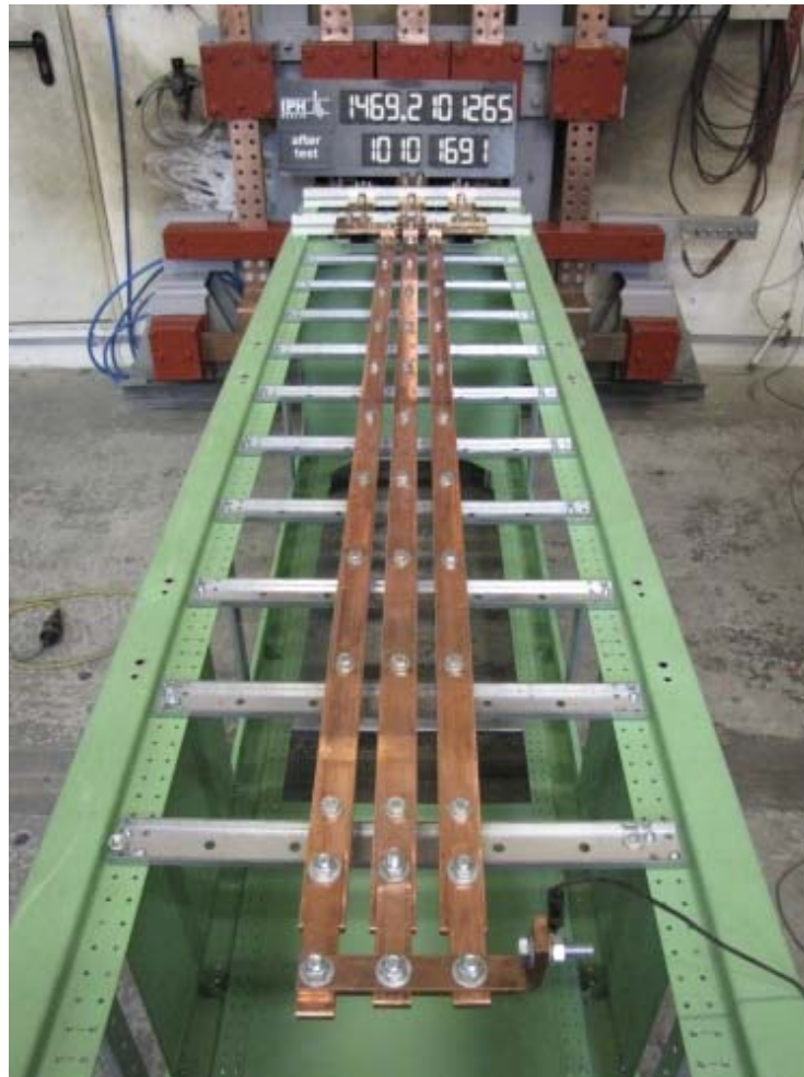
Foto 9: 40 mm x 10 mm-Sammelschienensystem, Stützabstand 200 mm nach der Stoßstromprüfung
