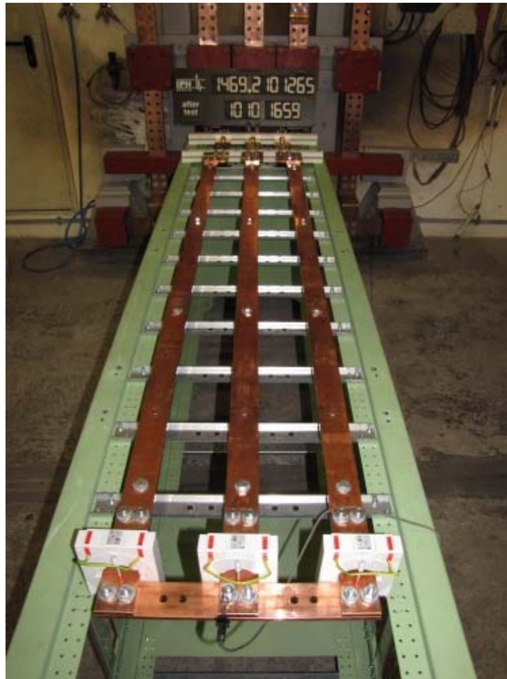
Foto 3: 60 mm x 10 mm-Sammelschienensystem, Stützabstand 600 mm nach der Stoßstromprüfung
