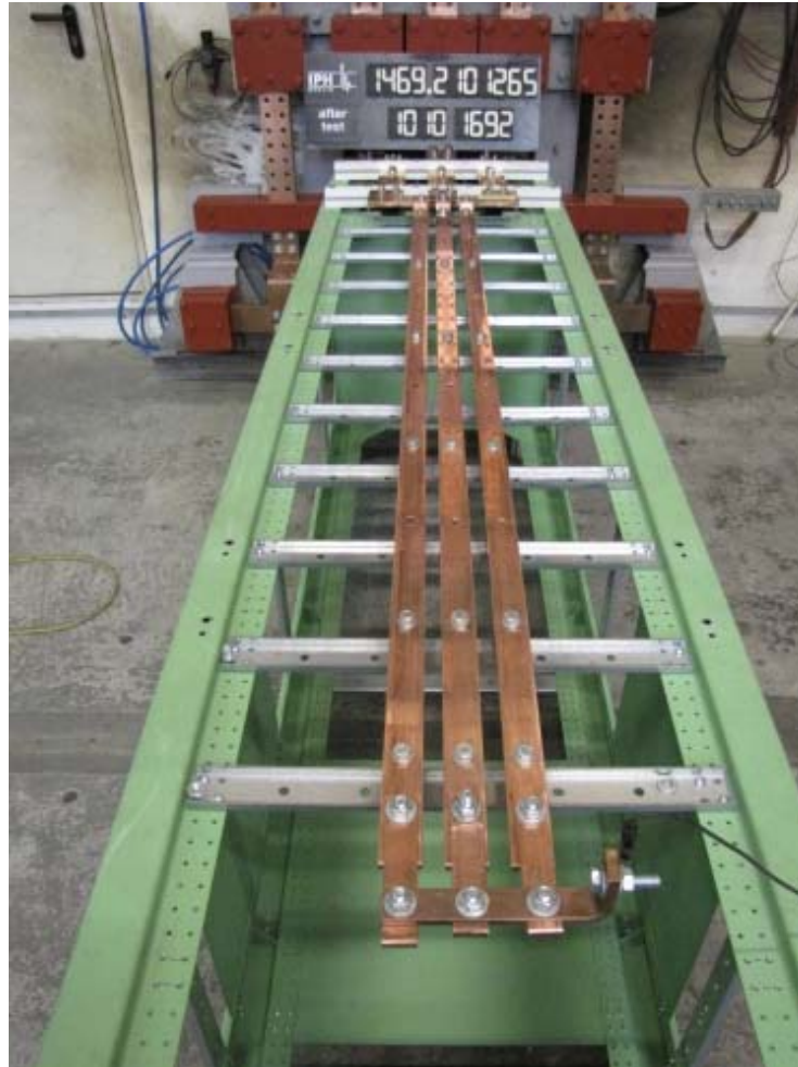
Foto 10: 40 mm x 10 mm-Sammelschienensystem, Stützabstand 400 mm nach der Stoßstromprüfung
