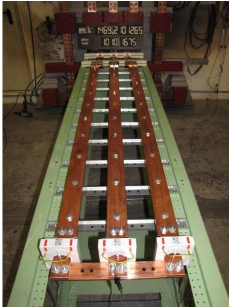
Foto 4: 80 mm x 10 mm-Sammelschienensystem, Stützabstand 200 mm nach der Stoßstromprüfung
