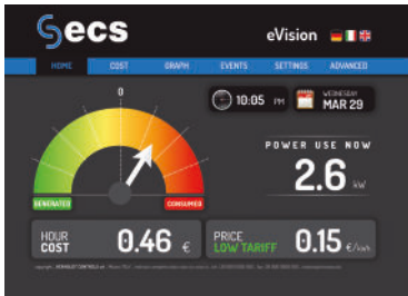
Home: Angabe des tatsächlichen Verbrauchs und der Stundenkosten Ihres Hauses oder Büros.
