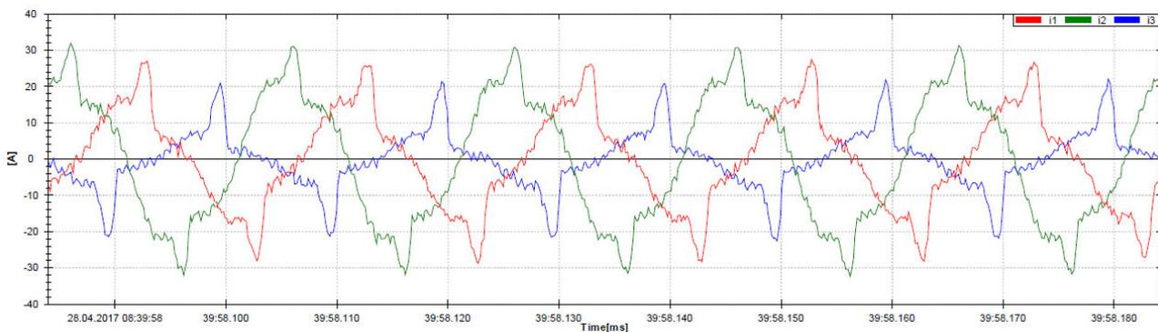
Abbildung 2: Stromverlauf eines Industriekunden im Mittelspannungsnetz
