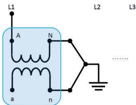
Anschluss eines Spannungswandlers VTLS(-L)
