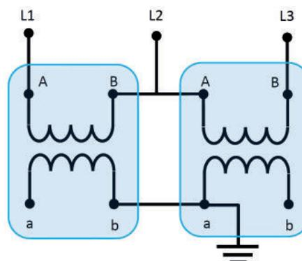
Anschluss von zwei Spannungswandlern VTLD(-L)
