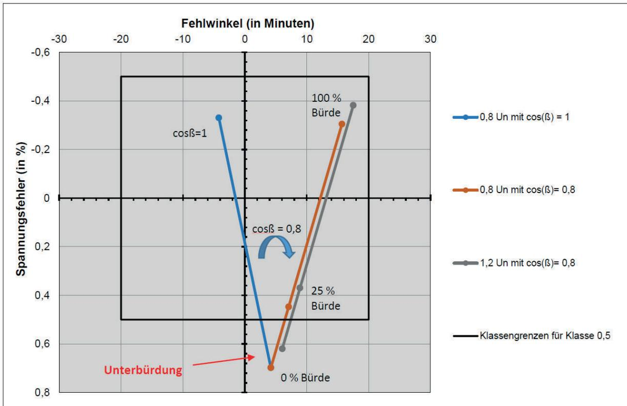
Abbildung 1: Beispielhaftes Fehlerdiagramm Spannungswandler BB II in Klasse 0,5
