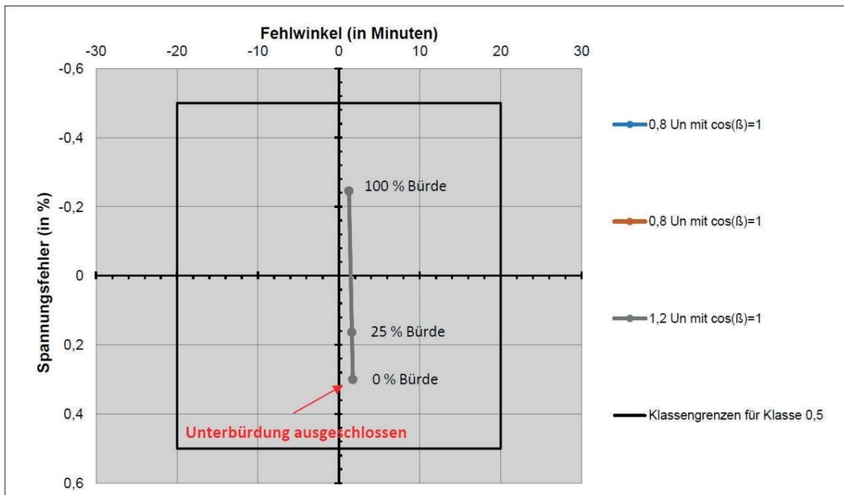
Abbildung 2: Beispielhaftes Fehlerdiagramm Spannungswandler BB I in Klasse 0,5
