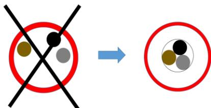
Zur Sicherstellung der größtmöglichen Messgenauigkeit, ist auf eine möglichst zentrische Anordnung aller zu erfassenden Leiter im Primärleiterfenster des Wandlers zu achten!
