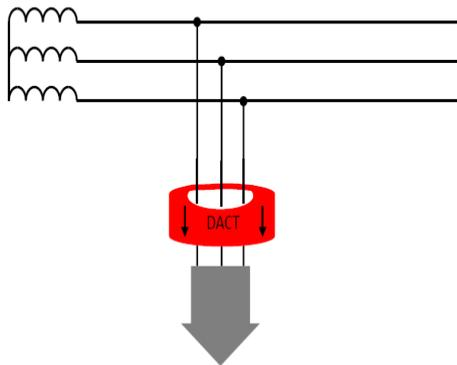
Bei der Installation der Wandler muss die Durchführungsrichtung der einzelnen Leitungen beachtet werden!
