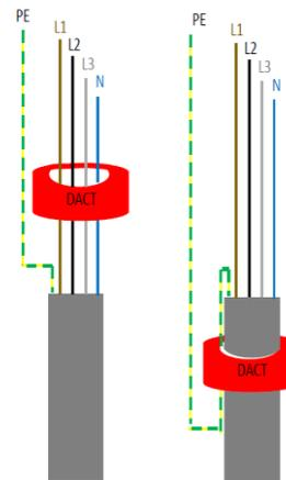
Vorhandene Schutzleiter dürfen generell nicht durch den Differenzstromwandler geführt werden! Es ist darauf zu achten, dass generell alle Leiter (Phase und Neutraleiter) durch den Wandler geführt werden!
