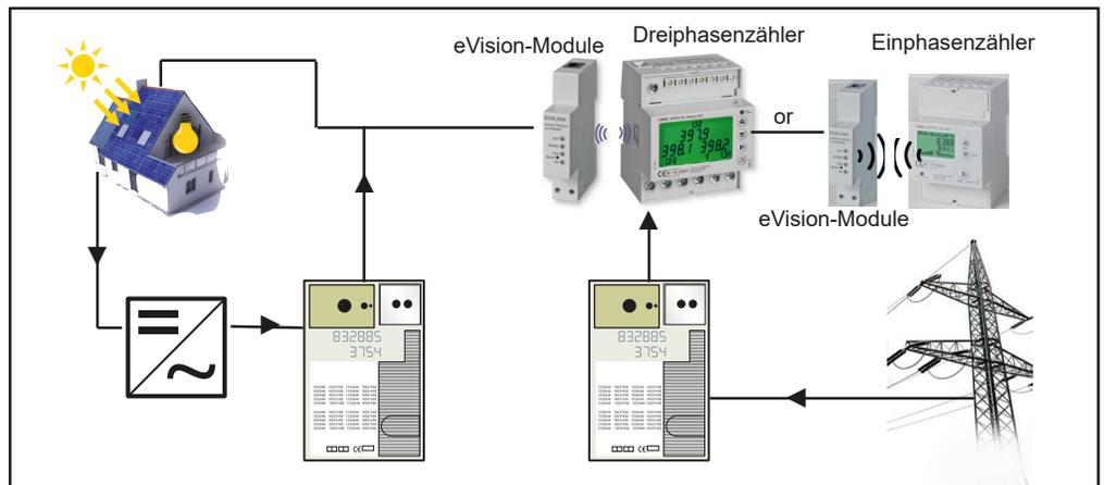
**Beispiel einer möglichen Installation für den Import und Export von Energien in eine Solaranlage oder Wireless.**
