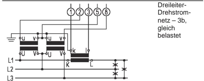
Dreileiter-Drehstromnetz – 3b, gleich belastet
