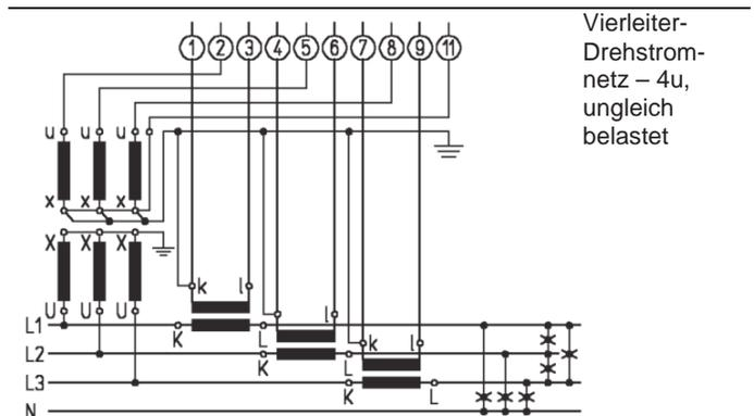
Vierleiter-Drehstromnetz – 4u, ungleich belastet
