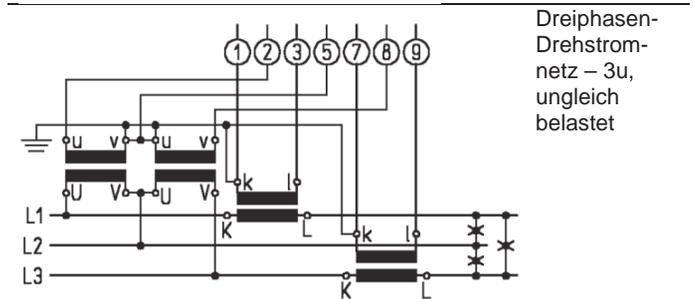
Dreiphasen-Drehstromnetz – 3u, ungleich belastet
